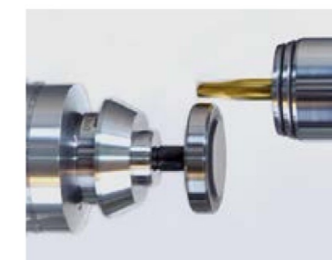
在卧式加工中心上使用特殊测杆 测量刀具半径
