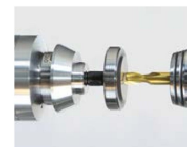
在卧式加工中心上使用特殊测杆 测量刀具长度
