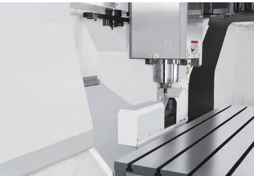
▲ 刀具量測儀器安裝於立柱旁，加工無干涉
