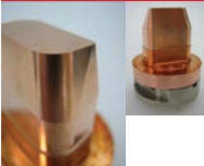
5 轴联动加工, 连续加工 5 个电极,
