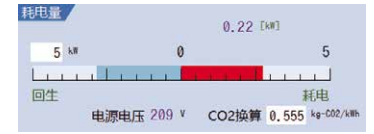
实时显示耗电量和回生电量
